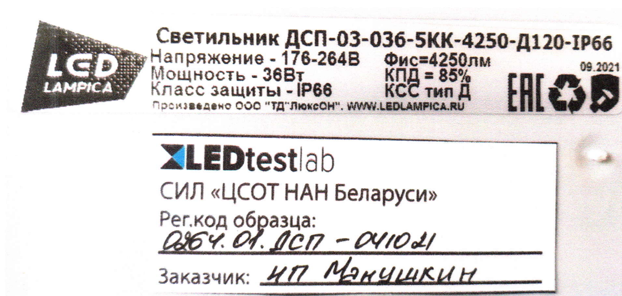
Рисунок 5 – Фотография маркировки и регистрационной этикетки образца светильник светодиодный ДСП-03-036-5КК-4250-Д120-IP66
